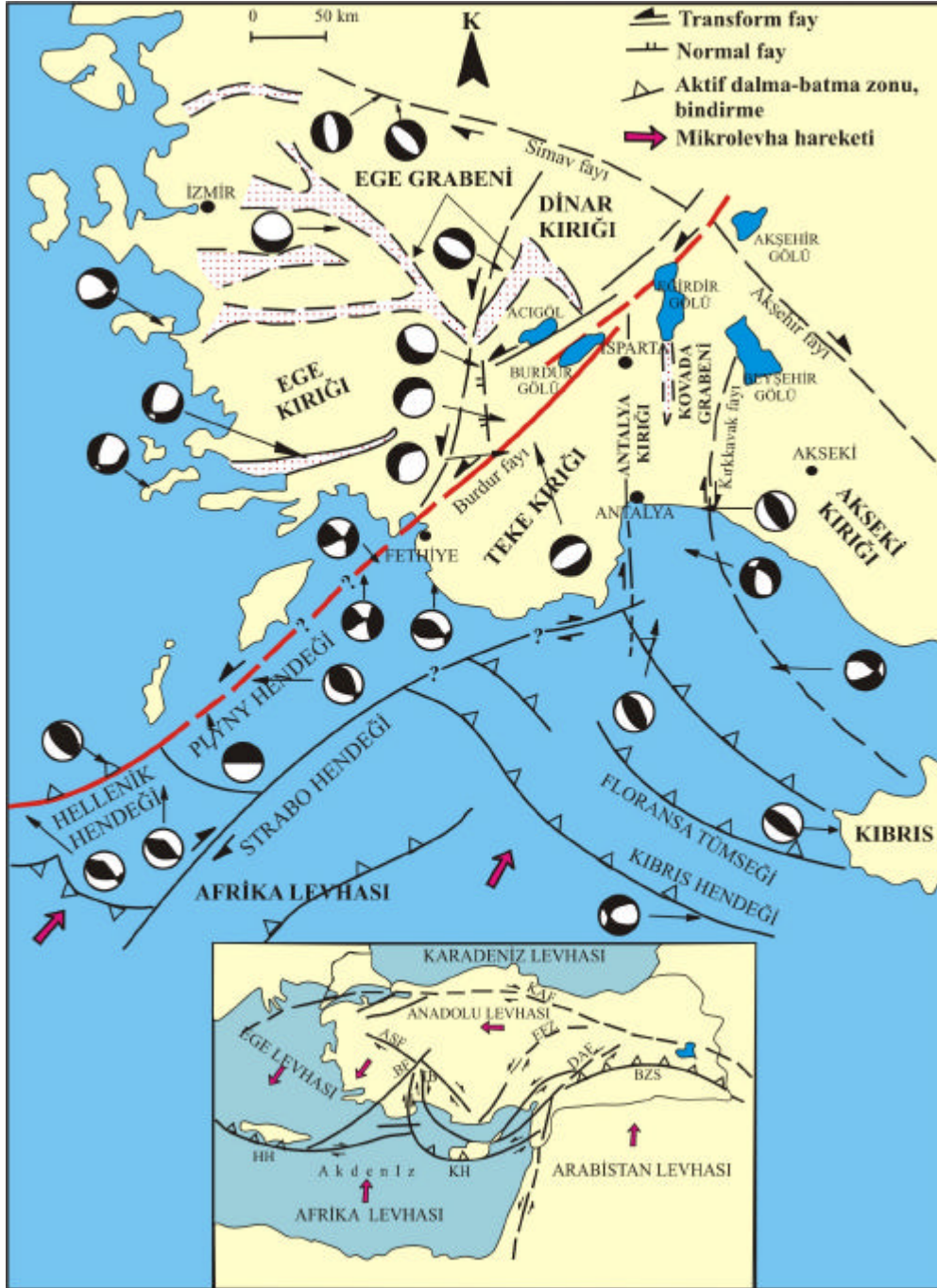
Sekil 1. Arastirma alanı ve yakın çevresinin tektonik konumuna bağlı olarak Burdur transform fayı (McKenzie, 1978; Dilek ve diğ., 1990 ve Anastakis ve Kelling, 1991).
