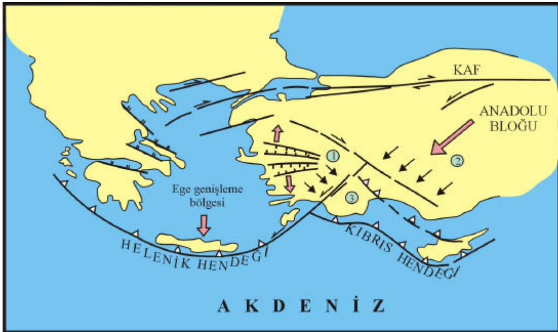
Sekil 5: Isparta Büklümü oluşum semasi (Yagmurlu ve dig., 2000). (1) Ege Bölgesi'nin genişleme rejimine bağlı olarak saat yönünün tersi yönde dönmesi, (2) Anadolu plakasının batıya doğru olan hareketine bağlı olarak saat yönünde dönmesi, (3) K-G sıkışma bölgesi.
