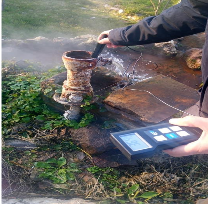
Şekil 4.3. Çalışma sahası içerisinde bulunan Zeytin dalı jeotermal su çıkış noktasında sıcaklık ölçümü (Zeytin Dalı Ilıcası)
