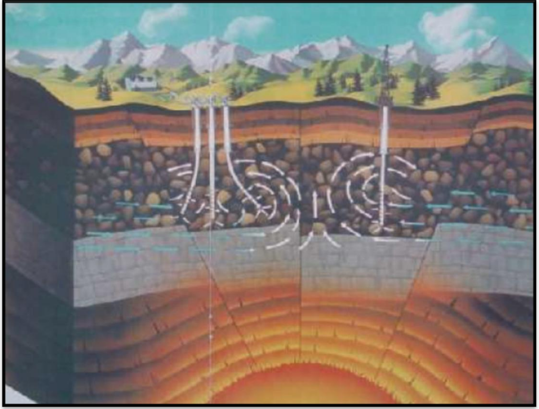
Şekil 1.4. Jeotermal sistemdeki rezervuar, üretim ve reenjeksiyon.
