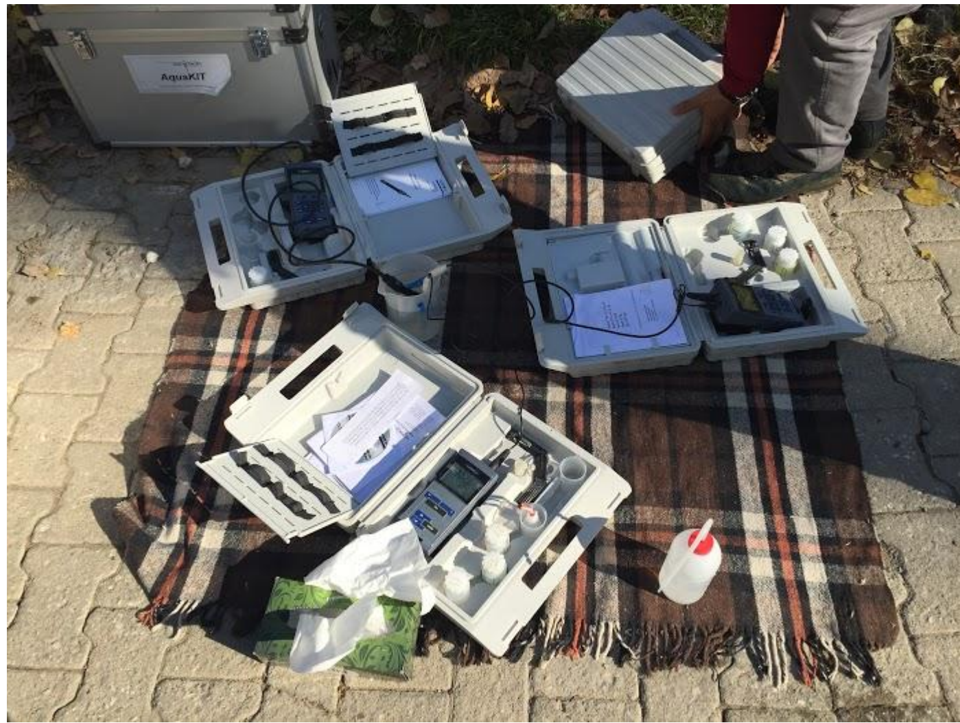
Şekil 2. Malgaçemir sıcak su kaynağında in-situ ölçümleri ve hidrojeokimyasal ve izotop jeokimyasal analizler için su örneği alımı.
